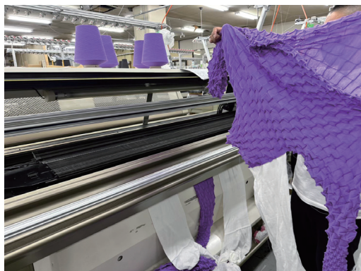
写真2 編み機から編み下がった整形済みの編地る (23年6月13日第一ニットにて中村光希撮影)
